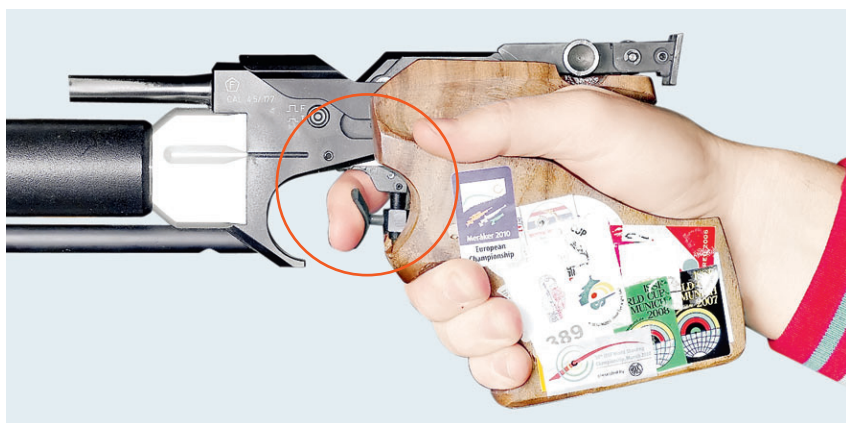
Правильное положение подушечки ногтевой фаланги на хвосте спускового крючка
