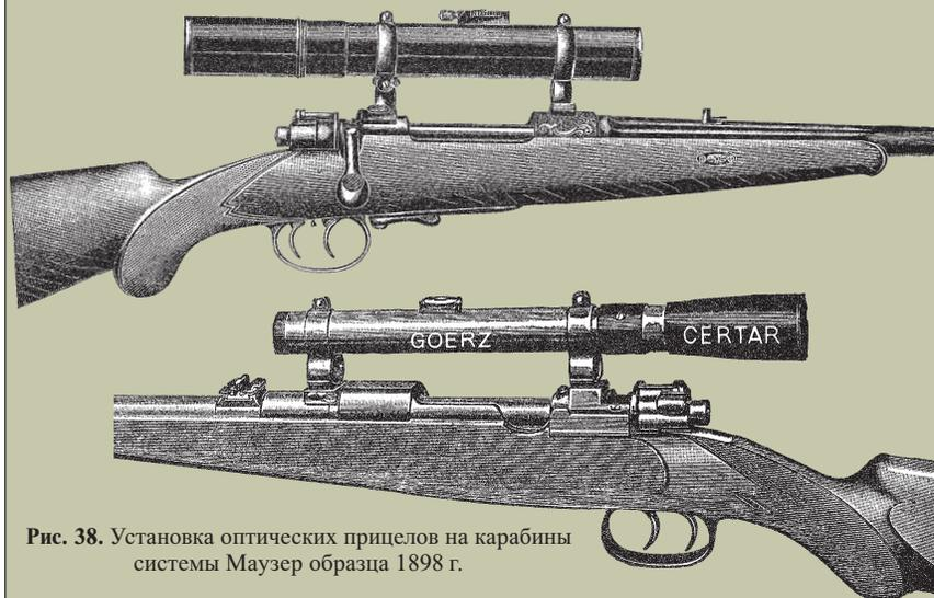
Рис. 38. Установка оптических прицелов на карабины системы Маузер образца 1898 г.
