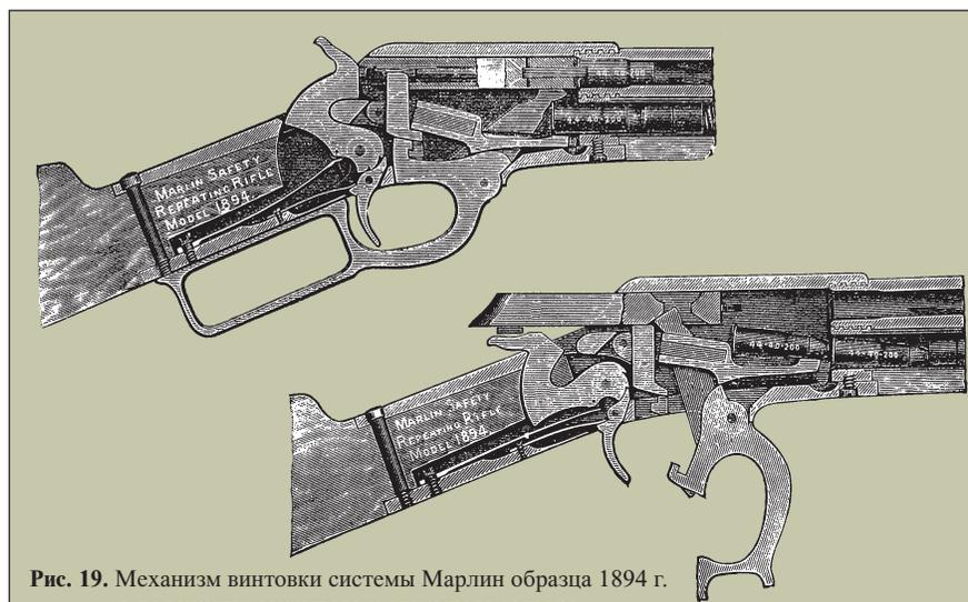
Рис. 19. Механизм винтовки системы Марлин образца 1894 г. в положении закрытого и открытого затвора
