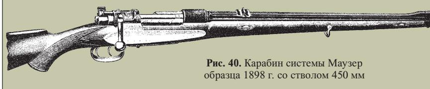
Рис. 40. Карбин системы Маузер образца 1898 г. со стволом 450 мм
