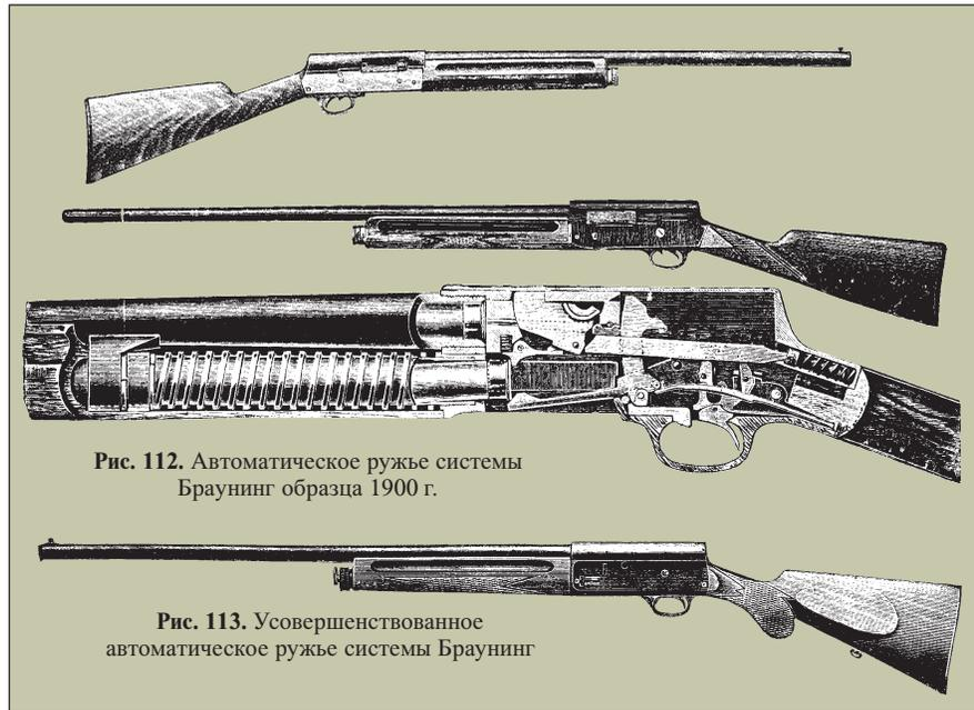
Рис. 112. Автоматическое ружье системы Браунинг образца 1900 г.
