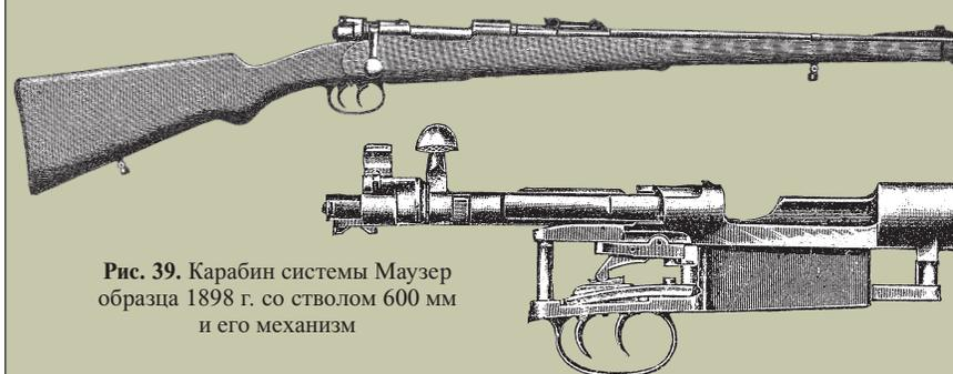
Рис. 39. Карбин системы Маузер образца 1898 г. со стволом 600 мм и его механизм
