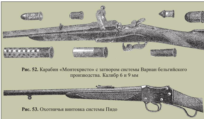
Рис. 52. Карабин «Монтекристо» с затвором системы Варнан бельгийского производства. Калибр 6 и 9 мм
