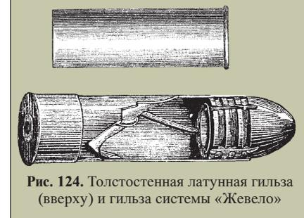
Рис. 124. Толстостенная латунная гильза (вверху) и гильза системы «Жевело»
