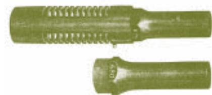
Рис. 116. Компенсатор системы Кутца для винтовки
