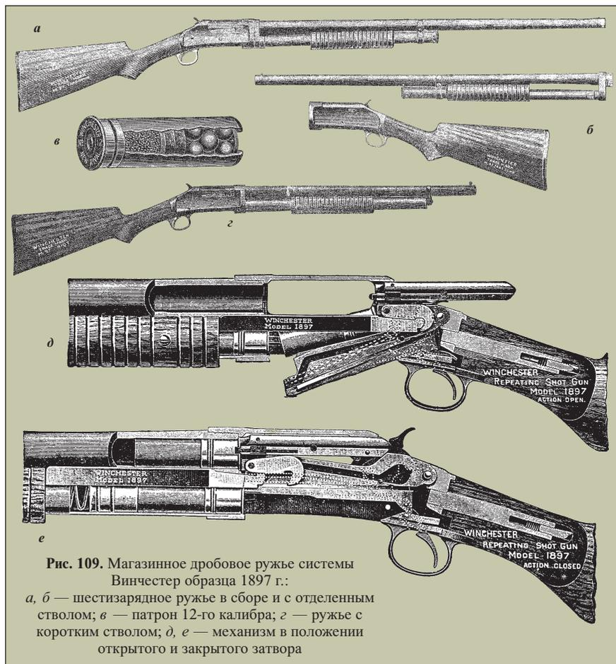
Рис. 109. Магазинное дробовое ружье системы Винчестер образца 1897 г.:
