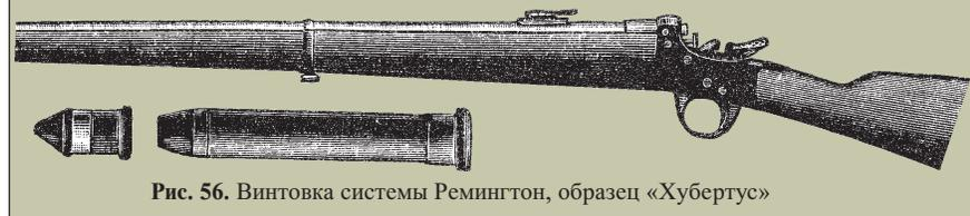
Рис. 56. Винтовка системы Ремингтон, образец «Хубертус»
