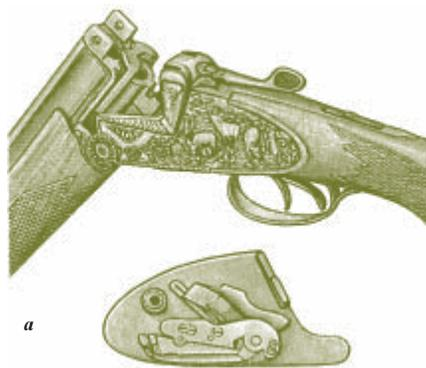
**Рис. 119.** Ударные механизмы: *а* — типа «Блиц» в ружье фирмы «Братья Меркель» в Зуле; *б* — замок типа Голланд—Голланд; *в* — системы Энсона—Дилей для бескуркового охотничьего ружья; *г* — системы Пэрдэй для бескуркового охотничьего ружья; *д* — подкладной бескурковый замок
