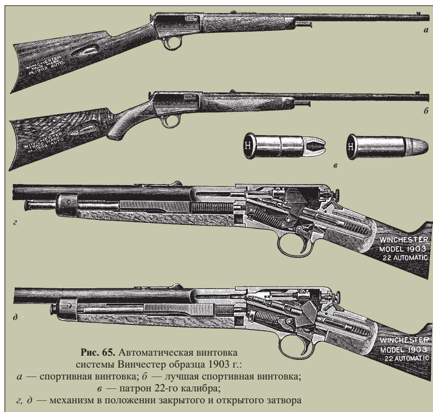
Рис. 65. Автоматическая винтовка системы Винчестер образца 1903 г.:
