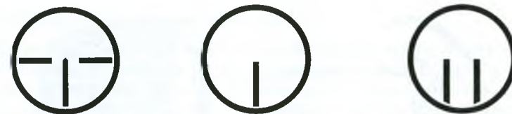
Рис. 6. Разновидности прицельных мушек в оптических прицелах
