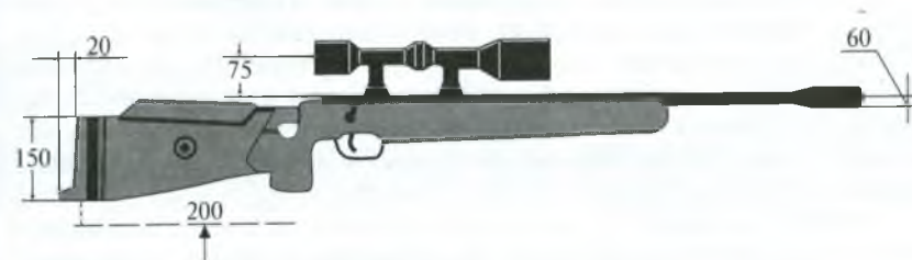
Рис. 23. Параметры винтовки для стрельбы по движущейся мишени, мм
