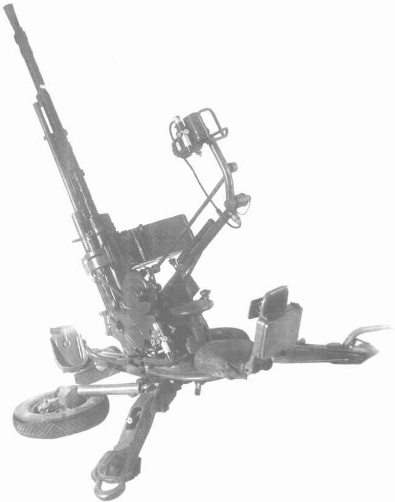
14,5-мм одиночное горно-вьючная зенитная установка ЗГУ-1 конструкции Пурцена и Рачинского под пулемет КПВМ
