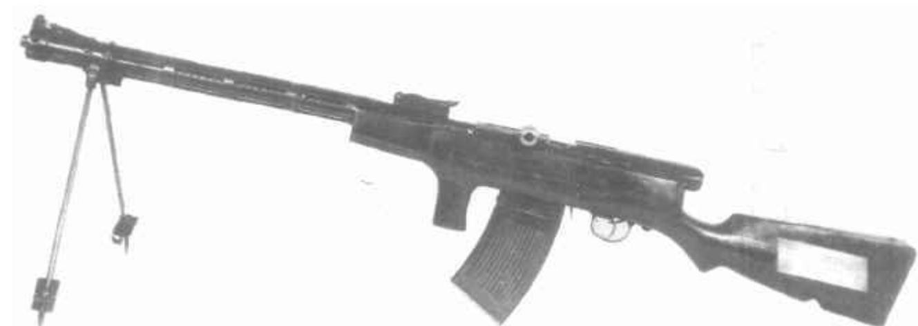
6,5-мм ручной пулемет системы Федорова-Дегтярева, опытный образец 1922 г.
