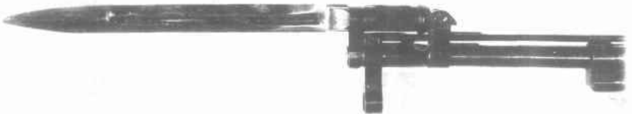
Клинковый штык 7,62-мм самозарядного карабина системы Симонова образца 1945 г. СКС-45 в боевом положении
