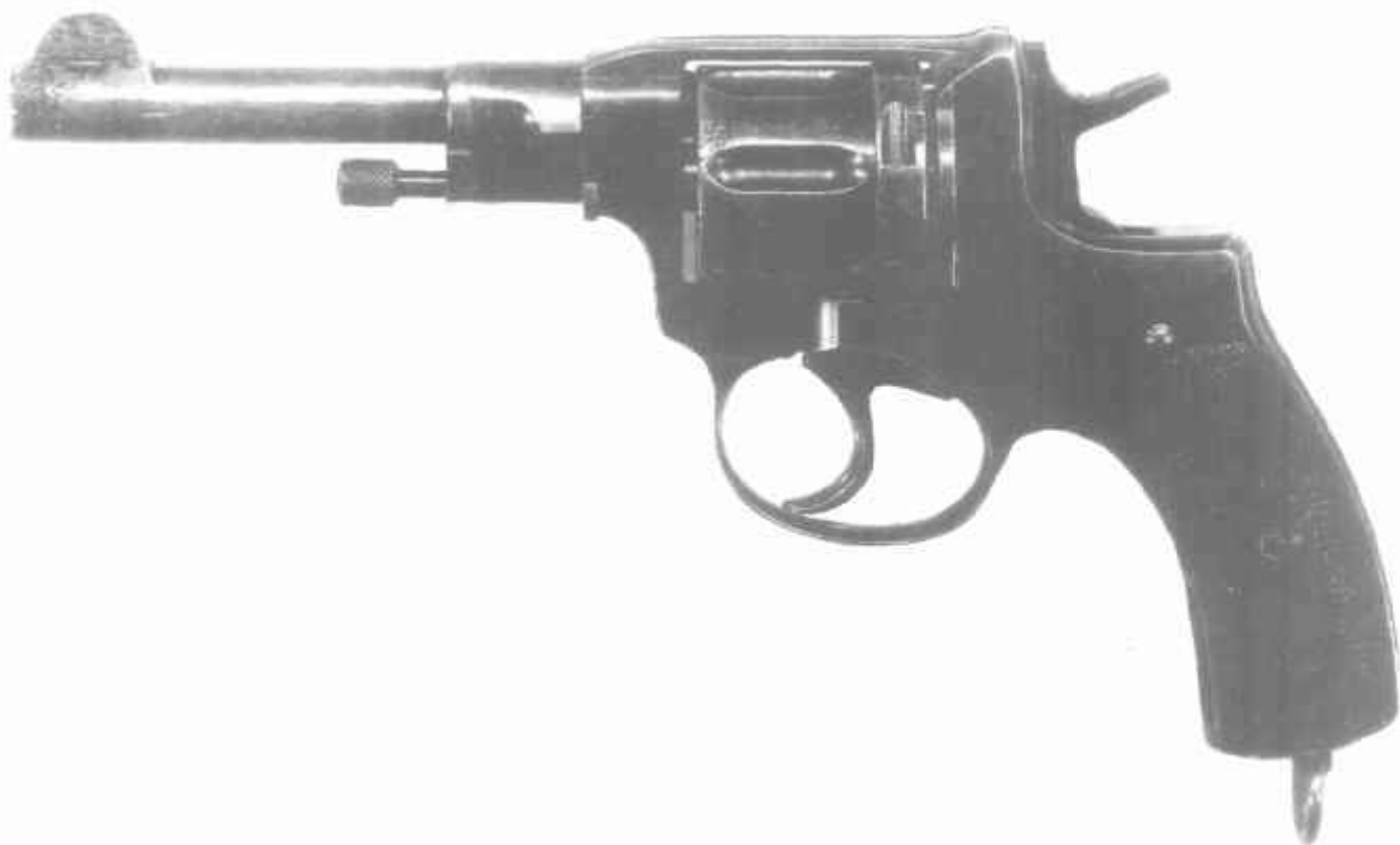
3-х линейный (7,62-мм) револьвер системы Нагана образца 1895 г.
