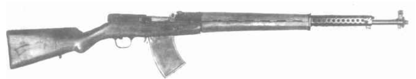
7,62-мм самозарядная винтовка системы Симонова, опытный образец 1938 г.
