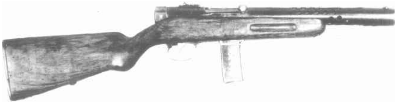
7,62-мм пистолет-пулемет системы Токарева, опытный образец 1931 г.
