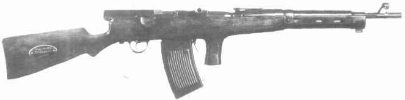
6,5-мм автомат системы Федорова образца 1916 г.
