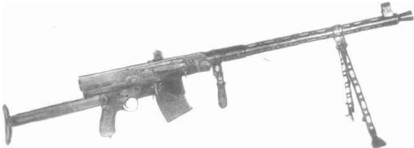
7,62-мм ручной пулемет системы Калашникова, опытный образец 1943 г.
