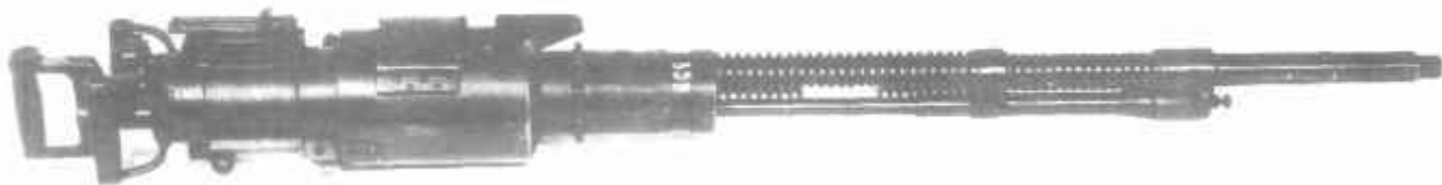
12,7-мм крупнокалиберный авиационный пулемет системы Шпитального-Владимирова ШВАК
