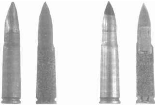
7,62-мм патрон образца 1943 г. со стальным сердечником и патрон с трассирующей пулей
