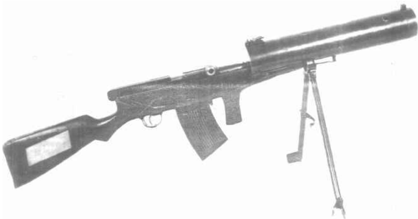
6,5-мм ручной пулемет системы Федорова-Дегтярева с водяным охлаждением, опытный образец 1922 г.
