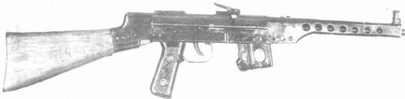
7,62-мм пистолет-пулемет системы Судаева под патрон образца 1943 г., опытный образец 1944 г.
