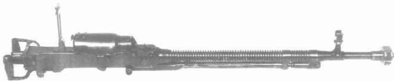
12,7-мм крупнокалиберный танковый пулемет ДШКТ
