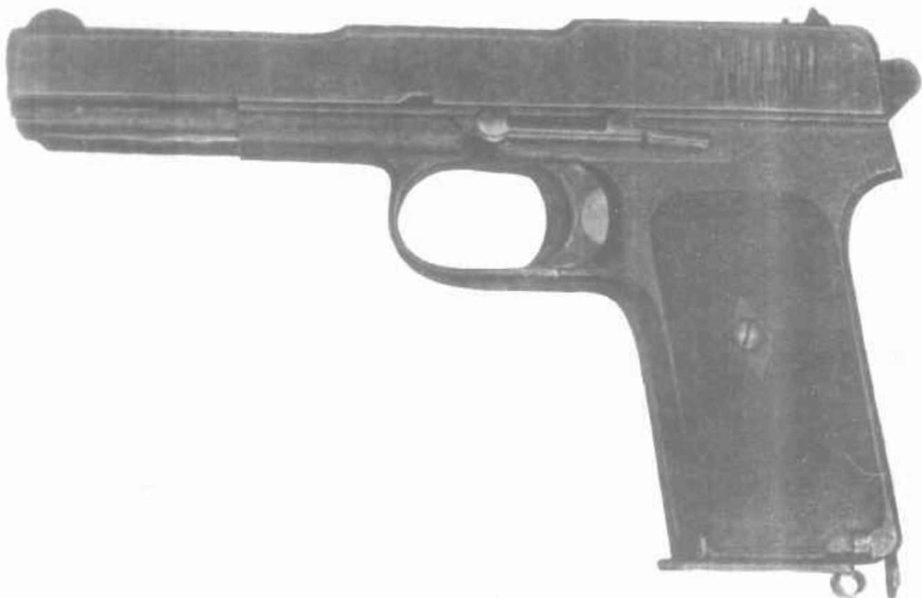
7,62-мм пистолет системы Прилуцкого, опытный образец 1932 г.
