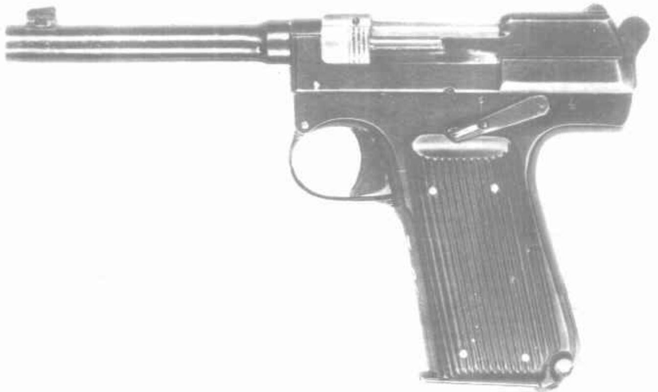
7,62-мм пистолет системы Токарева, опытный образец 1939 г.
