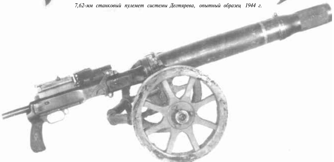
7,62-мм станковый пулемет системы Дегтярева на колесном станке, опытный образец 1944 г.
