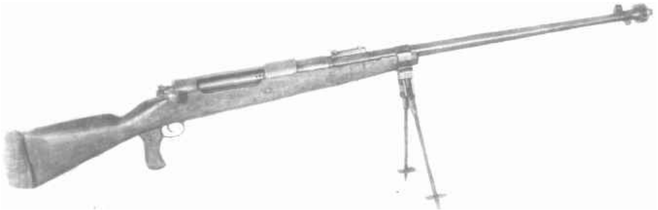
14,5-мм противотанковое ружье системы Рукавишников, опытный образец 1939 г.
