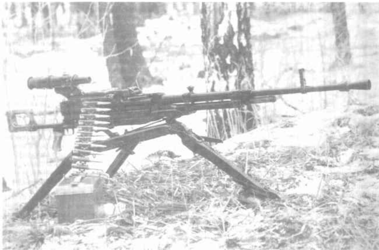
12,7-мм крупнокалиберный пулемет НСВ-12,7 на станке Степанова-Барышева
