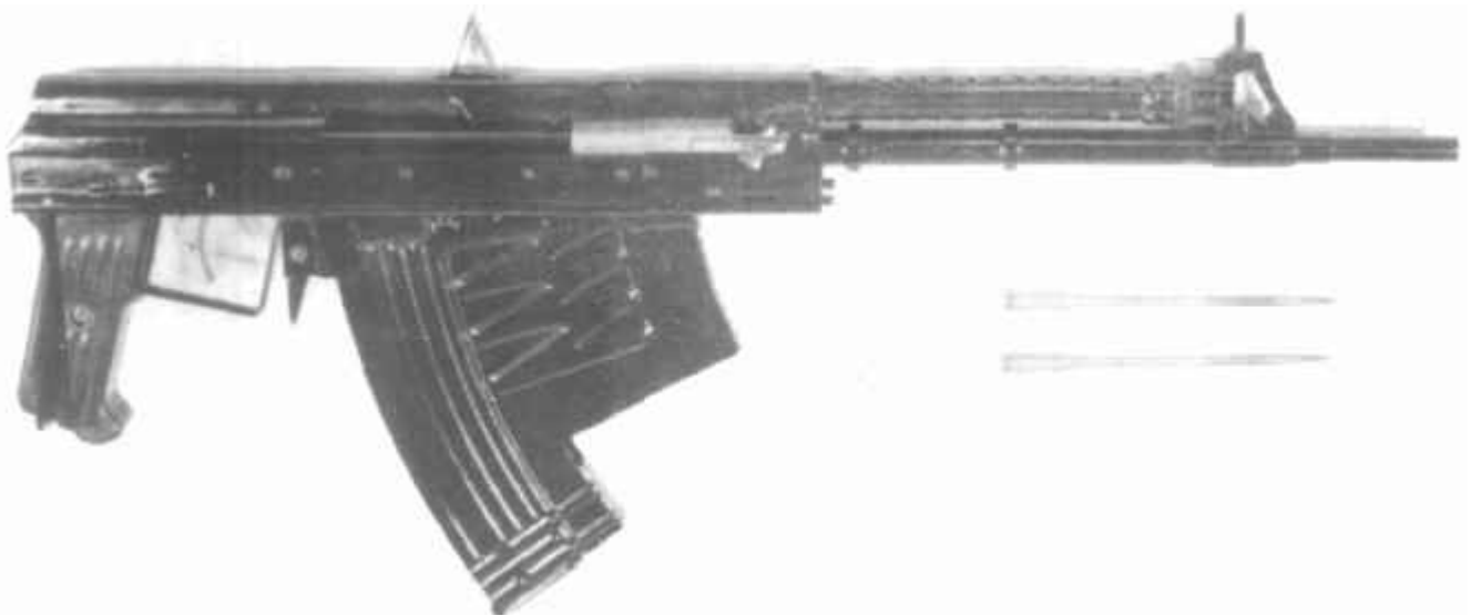
5,66-мм автомат подводной стрельбы специальный АПС и патроны к нему МПС
