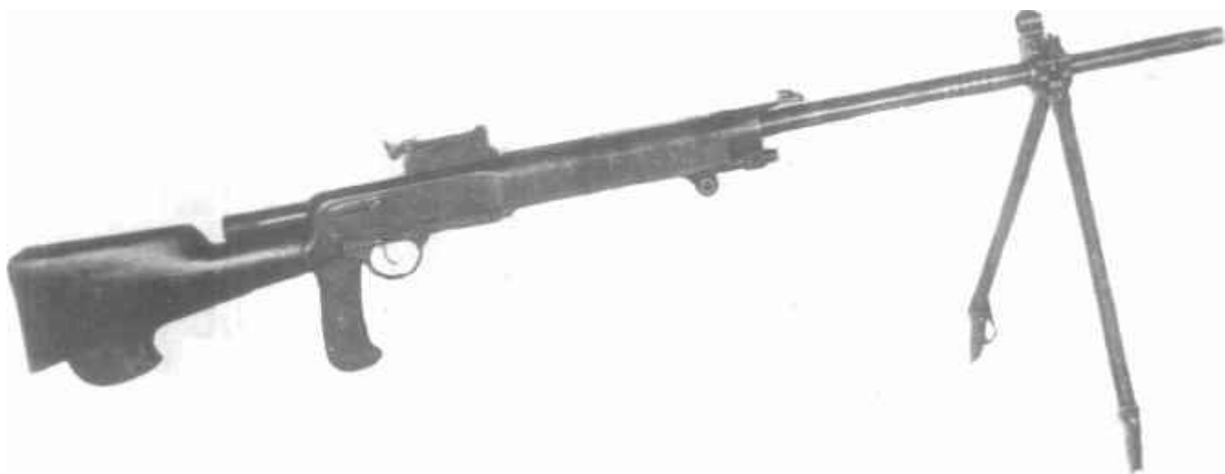
7,62-мм ручной пулемет системы Дегтярева, опытный образец 1931 г.
