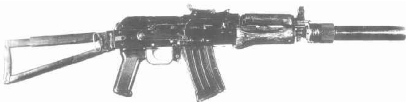
5,45-мм автомат системы Калашникова укороченный АКС-74УБ с приборами для бесшумной стрельбы ПБС
