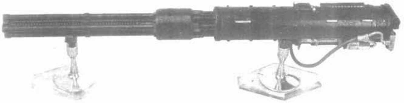
12,7-мм крупнокалиберный авиационный пулемет ЯкБ
