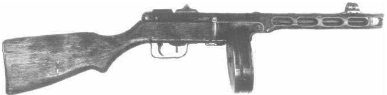
7,62-мм пистолет-пулемет системы Шпагина образца 1941 г. ППШ-41
