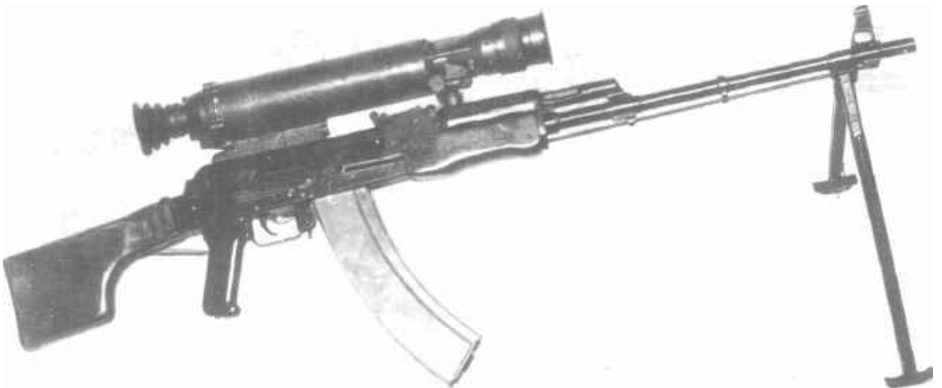
7,62-мм ручной пулемет системы Калашникова РПК с прибором ночного видения
