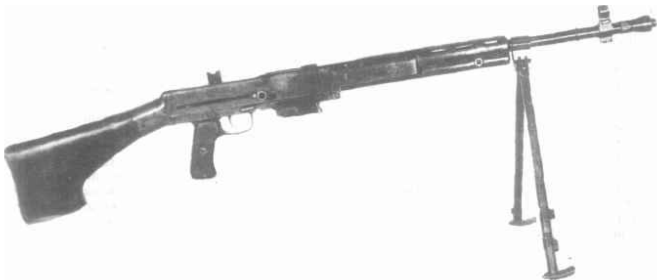
7,62-мм ручной пулемет системы Дегтярева под патрон образца 1943 г., опытный образец 1944 г.
