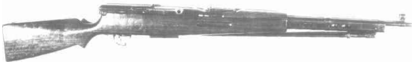
7,62-мм автоматическая винтовка системы Дегтярева, опытный образец 1925 г.
