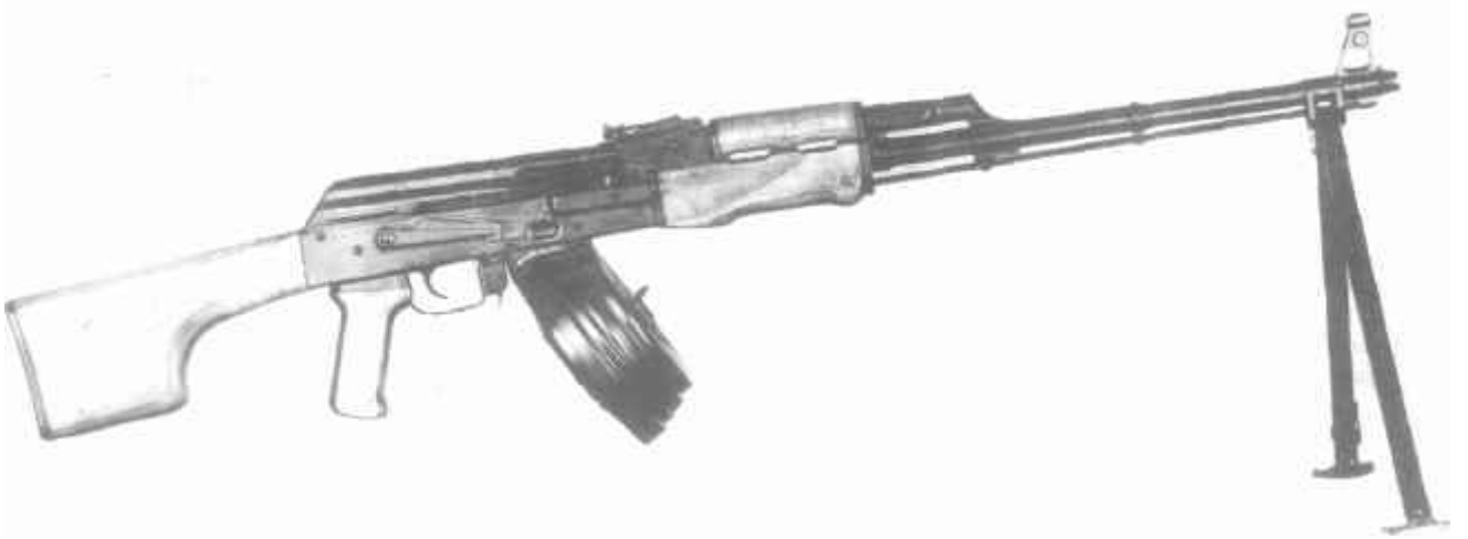
7,62-мм ручной пулемет системы Калашникова РПК с дисковым магазином
