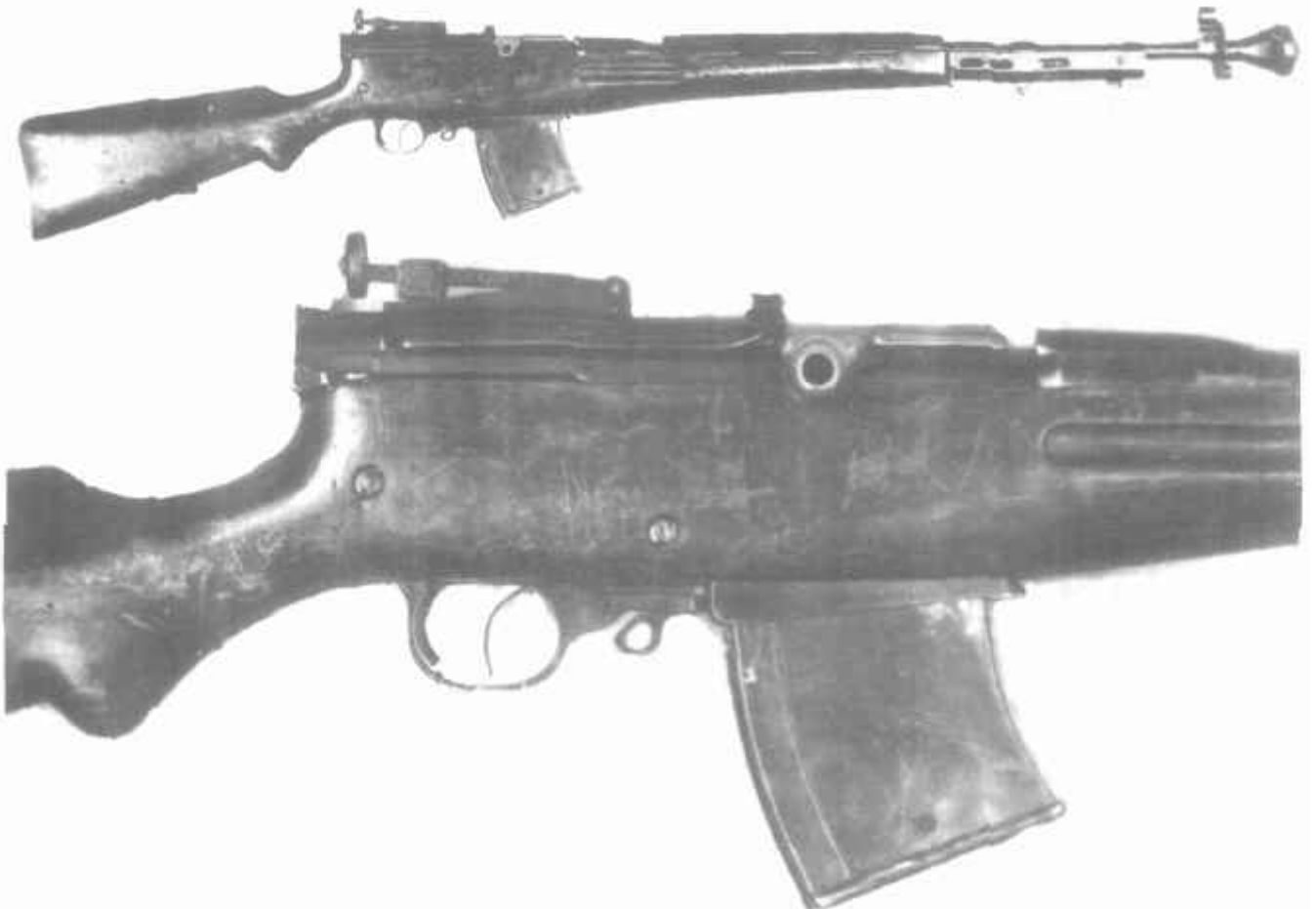
7,62-мм самозарядная винтовка системы Дегтярева, опытный образец 1930 г.
