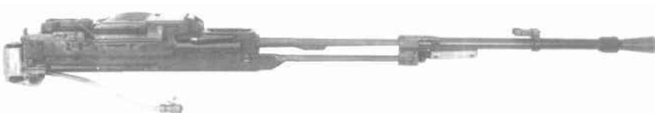
12,7-мм танковый пулемет НСВТ-12,7
