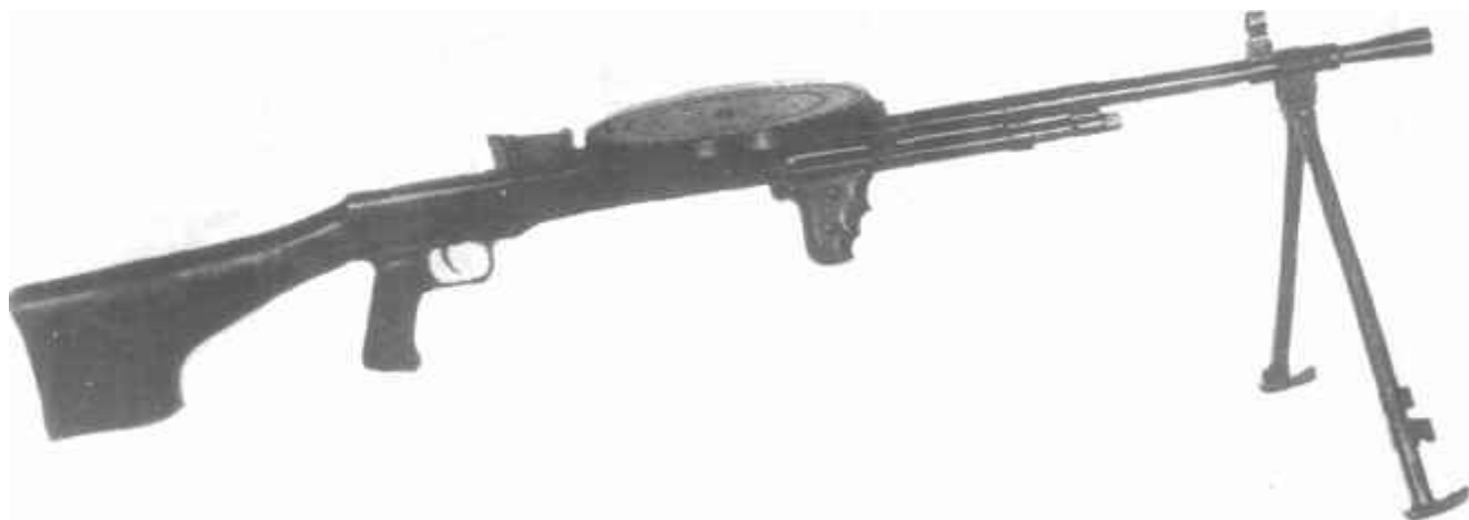
7,62-мм ручной пулемет системы Дегтярева под патрон образца 1943 г., опытный образец 1944 г.
