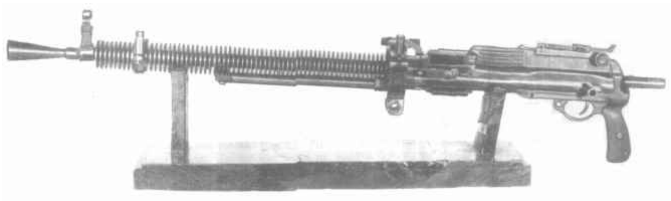
7,62-мм станковый пулемет системы Дегтярева, опытный образец 1934 г.
