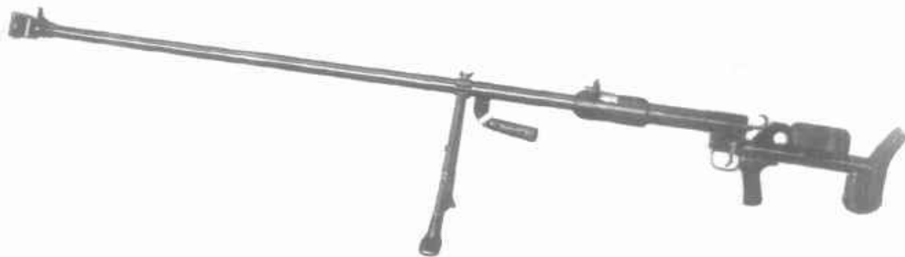
14,5-мм противотанковое однозарядное ружье системы Дегтярева образца 1941 г. ПТРД
