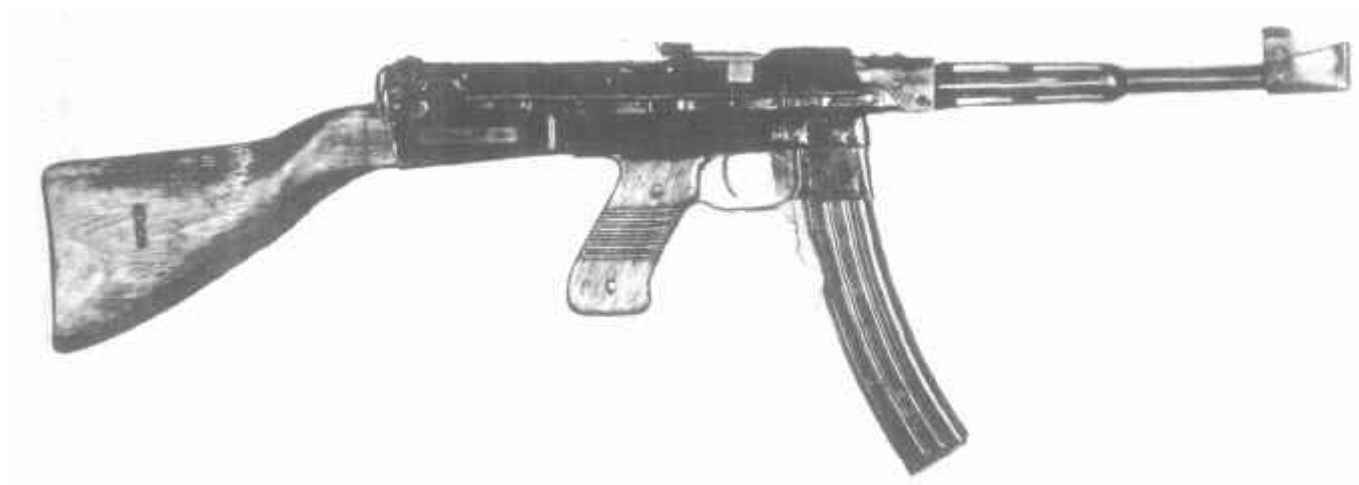
7,62-мм пистолет-пулемет системы Судаева образца 1942 г. ППС-42
