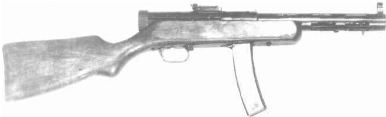
7,62-мм пистолет-пулемет системы Дегтярева образца 1934 г.
