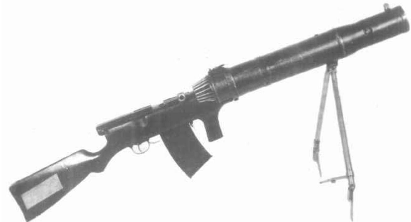
6,5-мм ручной пулемет системы Федорова-Дегтярева с водяным охлаждением, опытный образец 1921 г.
