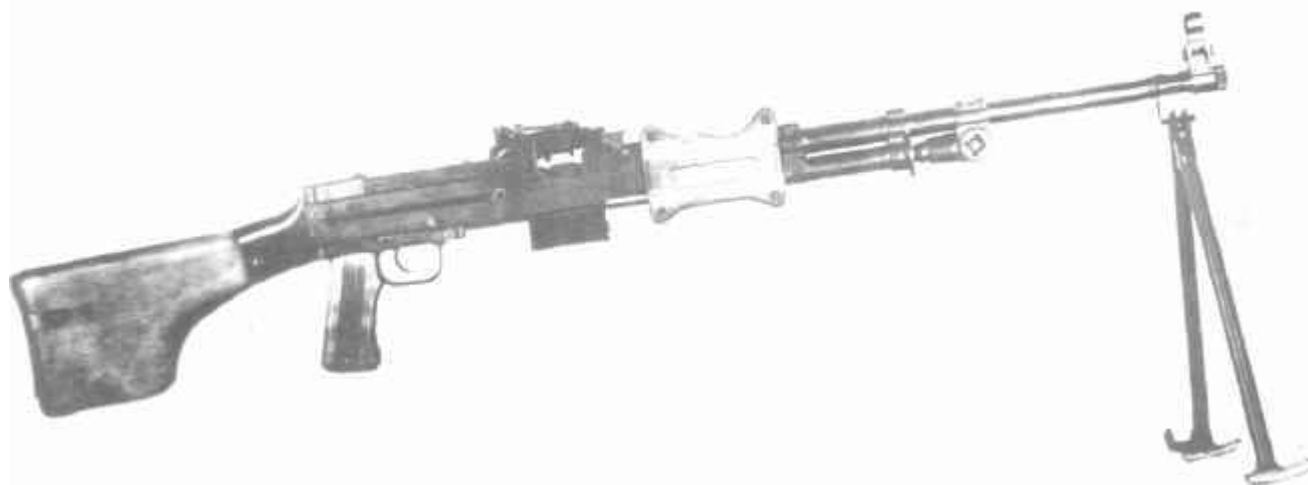
7,62-мм ручной пулемет системы Дегтярева образца 1944 г. РПД
