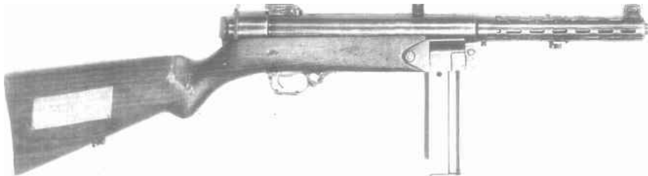
7,62-мм пистолет-пулемет системы Коровина, опытный образец 1930 г.
