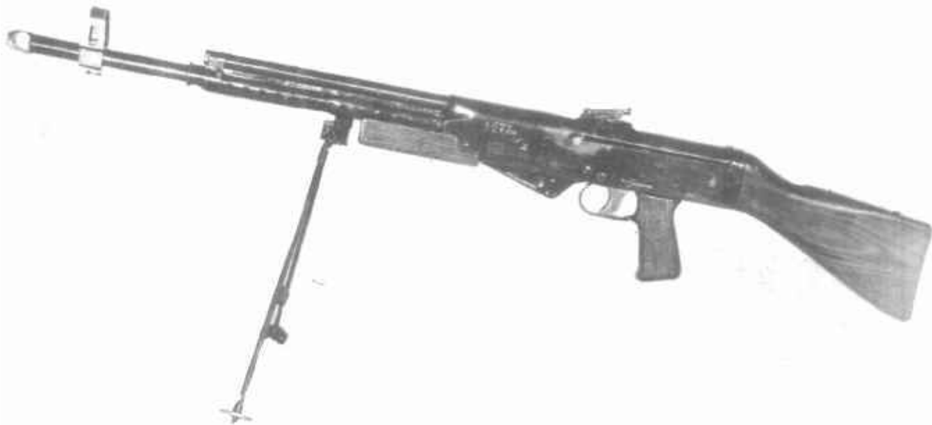
7,62-мм ручной пулемет системы Судаева под патрон образца 1943 г., опытный образец 1944 г.
