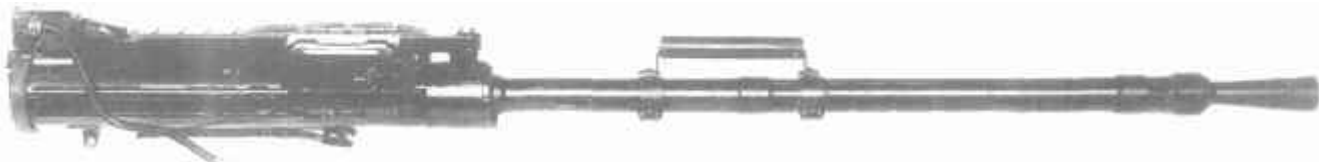
14,5-мм крупнокалиберный танковый пулемет системы Владимирова КПВТ
