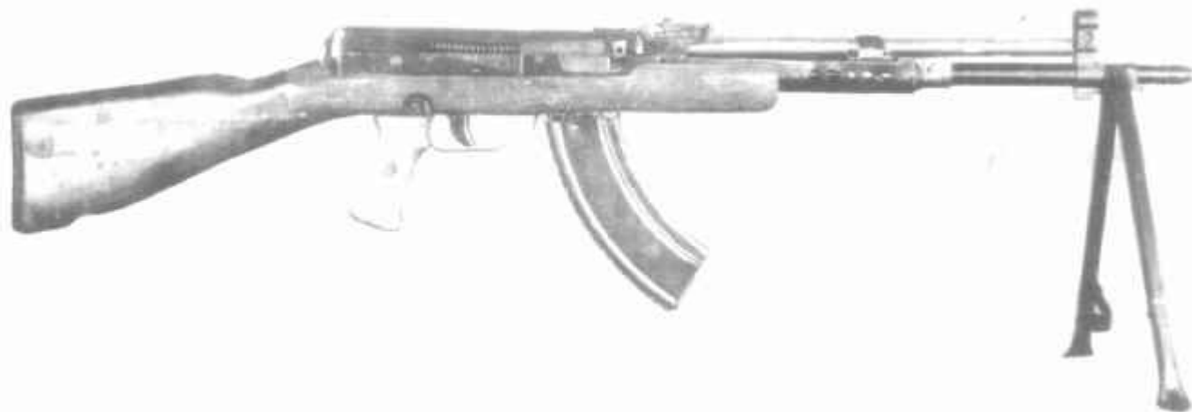
7,62-мм автомат системы Судаева под патрон образца 1943 г., опытный образец 1944 г.
