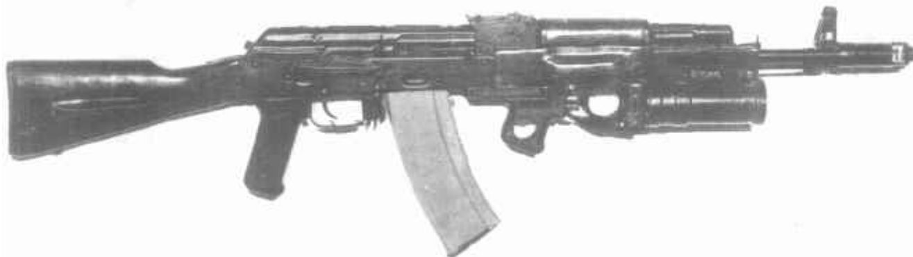
5,45-мм автомат системы Калашникова АК-74 с 40-мм подствольным гранатометом "ГП-25".
