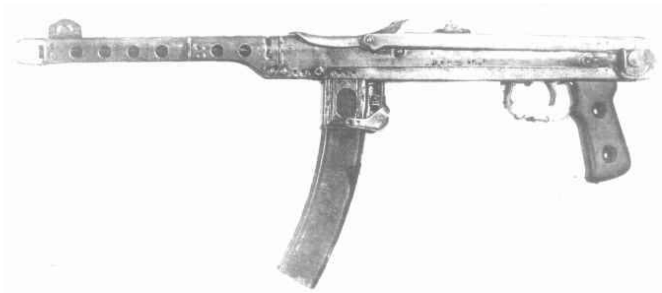
7,62-мм пистолет-пулемет системы Судаева образца 1942 г. ППС-42
