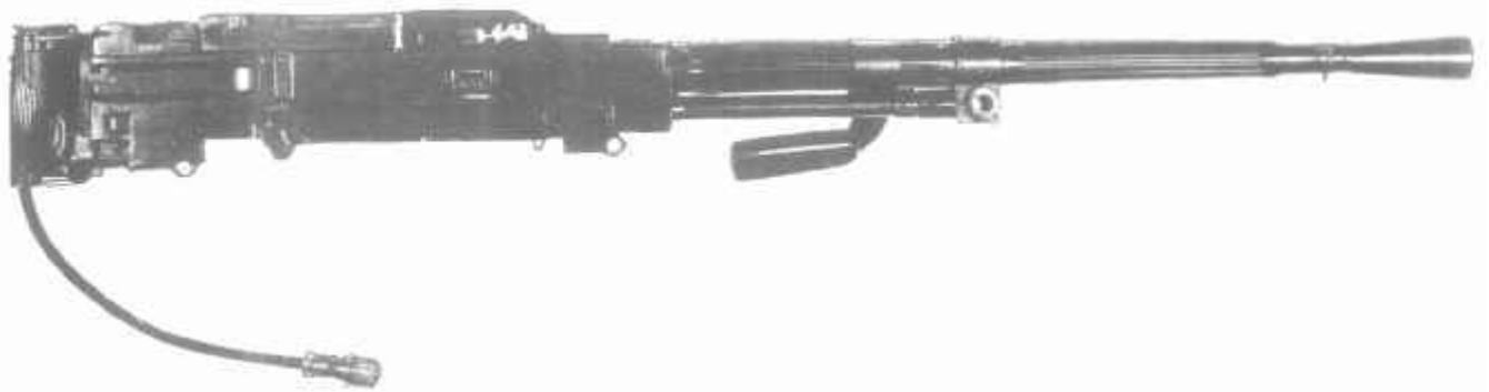
7,62-мм танковый пулемет системы Горюнова СГМТ
