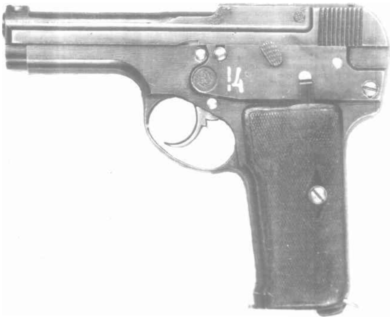
7,65-мм пистолет системы Коровина, опытный образец 1927 г.
