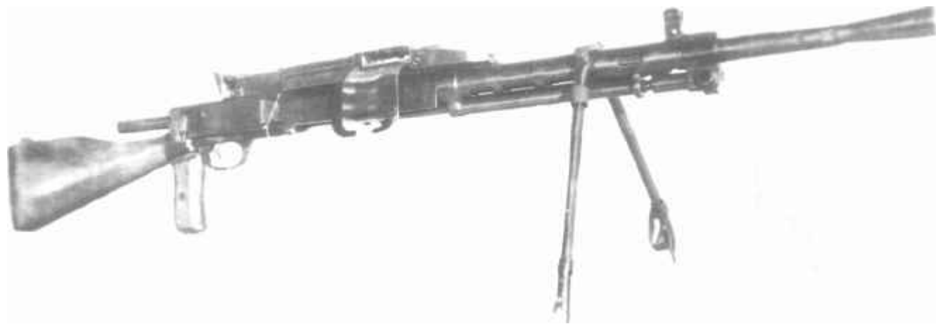
7,62-мм ротный пулемет образца 1946 г. РП-46
