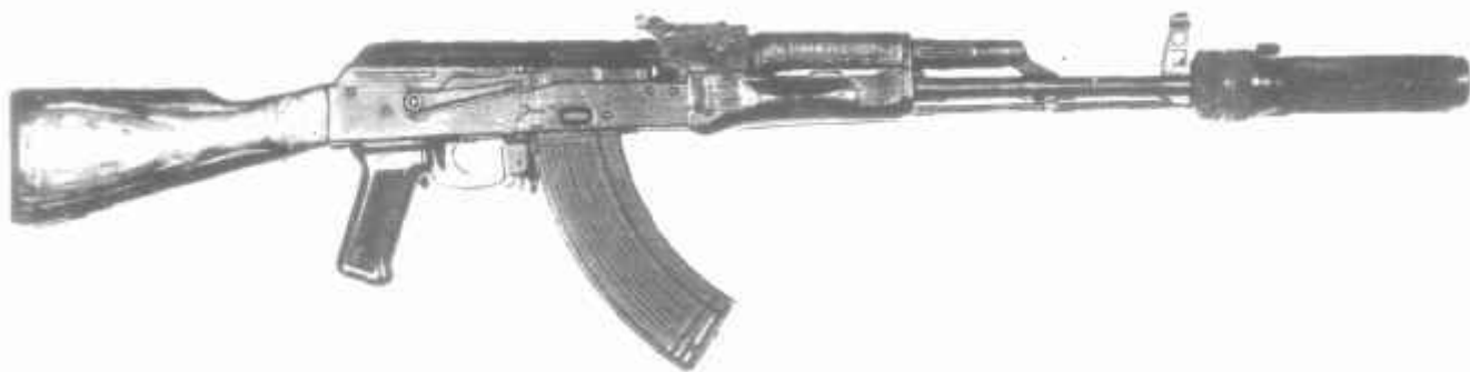
7,62-мм автомат системы Калашникова АКМ с приборами для бесшумной стрельбы
