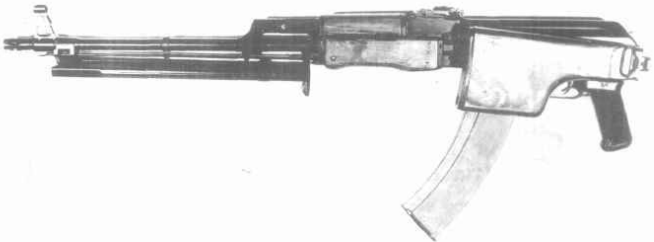
5,45-мм ручной пулемет системы Калашникова образца 1974 г. со складными сошками РПК-74 (вид слева)
