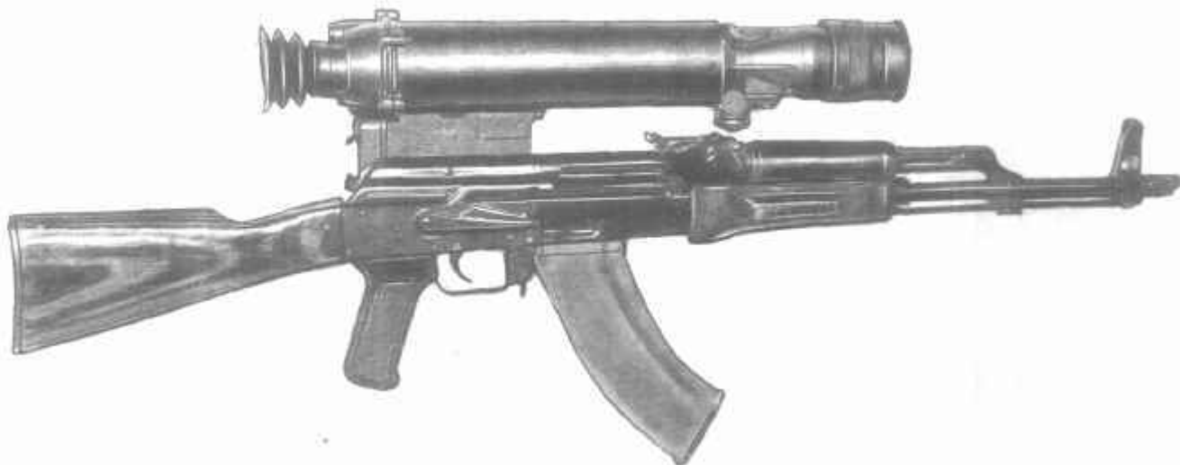
7,62-мм автомат системы Калашникова АКМ с прибором ночного видения
