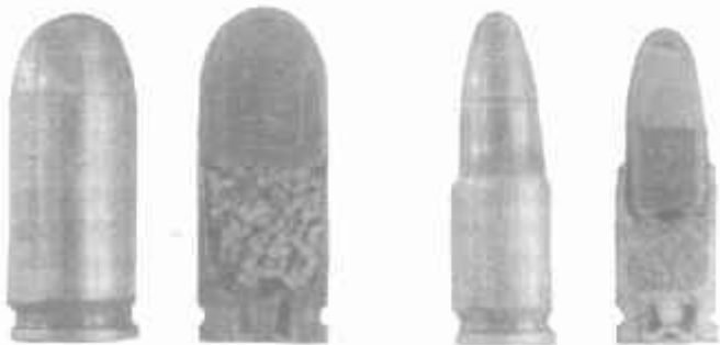
9-мм и 5,45-мм пистолетные патроны
