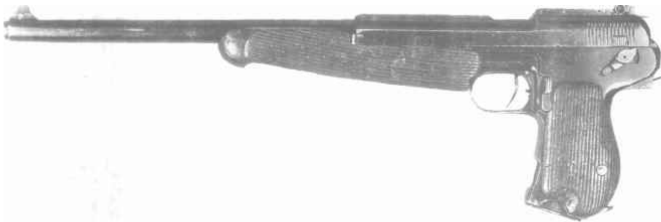
7,62-мм пистолет системы Токарева, опытный образец 1929 г.
