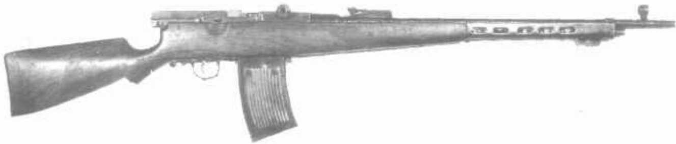
7,62-мм автоматическая винтовка системы Федорова, опытный образец 1925 г.
